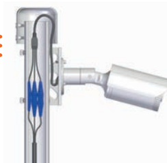
AM6075FZ Raccordo uscita cavi testa palo per pali Ø 60 ÷ 70 mm
