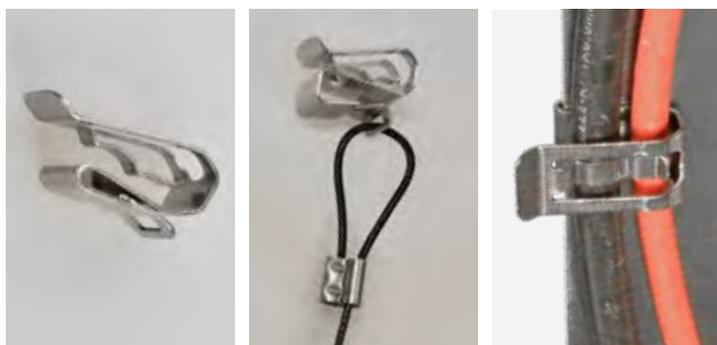
CMF-2C: **Clip per max 2 cavi.** Clip adatte per cavi con diametro 5,1 - 7,6 mm ciascuno, per spessore telaio 0,64 - 6,4 mm. Disponibili anche per telai con bordi molto stretti.
