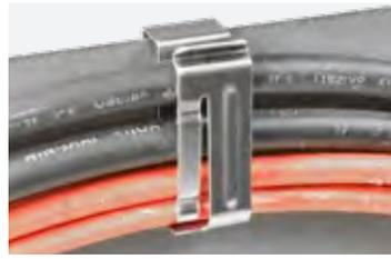
**CMF-4C: Clip per max 4 cavi.** Clip adatte per cavi con diametro 5,1 - 7,6 mm ciascuno, per spessore telaio 1,4 - 6,4 mm.
