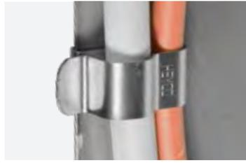
**CMF-RL: Clip per max 2 cavi, per sistemi senza profilati strutturali.** Clip adatte sia per i cavi dei pannelli fotovoltaici fino a diametro 7,6 mm sia per i cavi per micro-inverter fino a diametro 12 mm. Per spessore telaio 1,3 - 6,4 mm.
