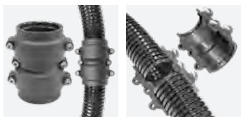
**Manicotti di riparazione IP 68/IP 69.** Realizzati in poliammide e TPE, antifiama e autoestinguenti UL94-V0, questi manicotti vengono utilizzati per creare solide giunture a tenuta stagna tra spezzoni di tubo corrugato. Si montano/smontano molto facilmente, sono resistenti all'impatto, sono adatti per applicazioni statiche o dinamiche e sono resistenti ai raggi UV.
