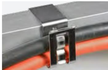
**CMF-SF: Clip per max 2 cavi, per moduli senza bordi.** Clip realizzate per i moduli fotovoltaici più recenti con telai privi del tipico bordo; vengono infatti installate direttamente sui telai. Adatte per cavi con diametro 5,1 - 8,4 mm ciascuno, per spessore telaio 13 - 18 mm.
