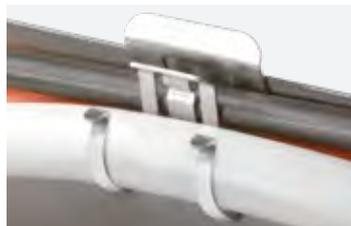
**CMF-1S: Clip per max 3 cavi (2+1 cavo sormontato).** Clip adatte sia per i cavi dei pannelli fotovoltaici con diametro 6,6 - 8,4 mm ciascuno sia per i cavi di collegamento con diametro 9,7 - 14,5 mm. Per spessore telaio 0,8 - 2 mm.
