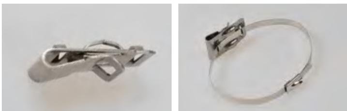
**HEYCLIP: Clip in acciaio inox per bordo telaio per il fissaggio delle fascette.** Realizzate in acciaio inossidabile 304 resistente alla corrosione, sono adatte per spessore telaio 1,5 - 6,4 mm. Consentono il fissaggio di fascette in metallo (con larghezza fino a 8 mm), orientate in parallelo o perpendicolarmente rispetto al bordo.
