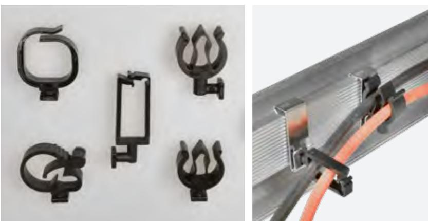
Ferma-cavi per clip modulari, disponibili in forma rettangolare (anche a 90°), in forma tonda con chiusura ad incastro e in forma ad albero (anche a 90°). Si agganciano alle clip modulari tipo CMF-CM e CPS-CM e consentono di fissare e organizzare cavi e fasci di cavi in varie dimensioni.
