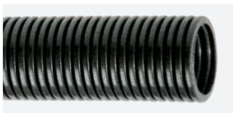
**PP: Tubo corrugato in polipropilene (UL94-HB).** Tubo con buona flessibilità e un'elevata resistenza all'acqua, alle soluzioni idrate, agli alcali e agli acidi, oltre a un'ottima resistenza ai solventi. Offre una buona protezione dai raggi UV e eccellenti proprietà di isolamento poiché le caratteristiche del materiale non sono influenzate dall'umidità. Disponibile con diametro interno 6,9 - 48 mm max.
