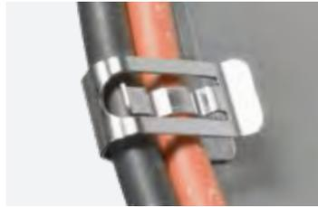
**CMF-IN: Clip per max 2 cavi, con cavi all'interno del telaio.** Clip orientate in modo che i cavi siano nascosti all'interno del telaio del modulo fotovoltaico. Adatte per cavi con diametro 5,1 - 8,4 mm ciascuno, per spessore telaio 1,4 - 3,2 mm.
