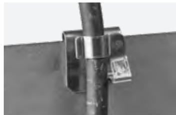
**CMF-90-1: Clip a 90° per max 1 cavo.** Clip progettate per fissare i cavi in posizione perpendicolare al telaio del modulo fotovoltaico. Adatte per un cavo con diametro 5,1 - 8,4 mm, per spessore telaio 1,4 - 3,2 mm.
