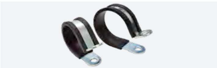
SKM/SKM-E: **Collarini in acciaio zincato con rivestimento in gomma oppure in EPDM.** Antifiamma e autoestinguenti, sono adatti per il fissaggio di tubi e fasci di cavi. Il rivestimento offre protezione, funzione antivibrazione, eccellente isolamento elettrico e resistenza a ozono, raggi UV e agenti atmosferici (EPDM).
