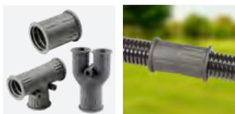
**Manicotti di accoppiamento e di derivazione.** Realizzati in morbido TPE resistente ai raggi UV, con forma dritta, a "Y" o a "T" questi manicotti vanno montati a pressione sulle estremità dei tubi e, grazie alla dentellatura interna, aderiscono perfettamente al profilo esterno dei tubi. Vengono utilizzati per creare una prolunga oppure una derivazione tra spezzoni di tubo, anche di dimensioni diverse.
