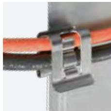
**CMF-BI: Clip bidirezionali per max 2 cavi.** Clip con doppio aggancio in modo da poter essere installate sia verticalmente che orizzontalmente. Adatte per cavi con diametro 5,1 - 8,4 mm ciascuno, per spessore telaio 1,1 - 2 mm.
