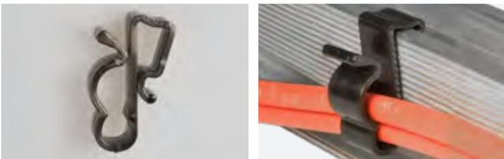
**CPS-2C-P: Clip in plastica per max 2 cavi.** Clip adatte per cavi per micro-inverter con diametro 7,6 - 12 mm ciascuno, per larghezza bordo del profilato 2 - 9,7 mm. Sono le uniche realizzate in poliammide 66 con ottima resistenza meccanica, resistenza ai raggi UV e protezione contro la corrosione.
