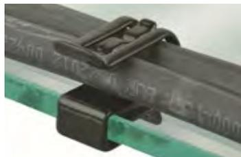
**CMF-PV: Clip per max 2 cavi, per pannelli in vetro.** Clip realizzate per essere installate direttamente sul pannello in vetro. Progettate per preservare l'integrità della superficie del vetro, sono rivestite in TPE per garantire un efficace isolamento elettrico. Adatte per cavi con diametro 5,1 - 8,4 mm ciascuno, per spessore telaio 3,2 - 6,4 mm.
