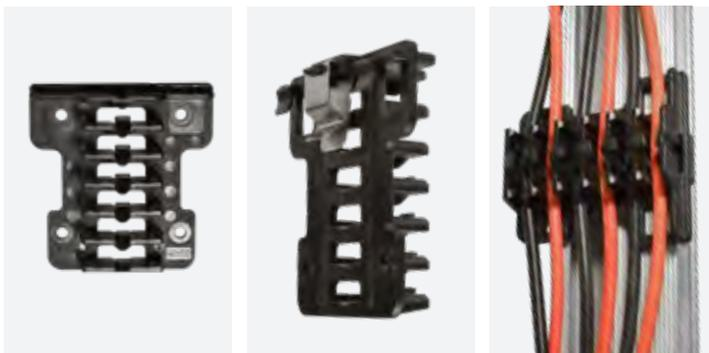
**MAXRUNNER: Piastre porta-cavi con fissaggio a vite oppure tramite clip in acciaio inox.** Progettate per organizzare i cavi in modo sicuro grazie alle linguette di bloccaggio che ne garantiscono una salda tenuta. Possono contenere fino a 12 cavi con diametro 5,2 e 7,2 mm ciascuno. La piastra con clip in acciaio inox permette il montaggio su profilati con bordi di larghezza 1,5 - 6,4 mm. Realizzate in PPE+PS UL94-V0, offrono un'eccellente resistenza agli agenti atmosferici.
