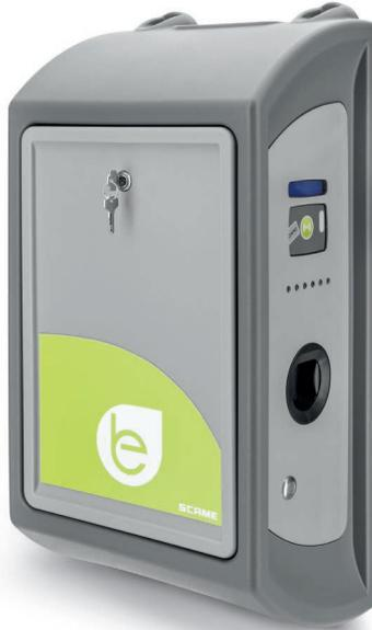
Il Dual Wall Box è una stazione di ricarica con le stesse caratteristiche delle colonnine CA e CB ma caratterizzata da una struttura plastica ad elevata resistenza e dalla possibilità di montaggio a parete. Indicata per ambienti in cui non sia possibile la soluzione a basamento (es. autorimesse interrate) è equipaggiabile con 1 o 2 prese da incasso con blocco antistrasazione Tipo 2, 3A.
