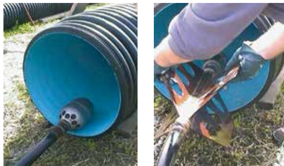
Prove di abrasione per mezzo di sonde.
